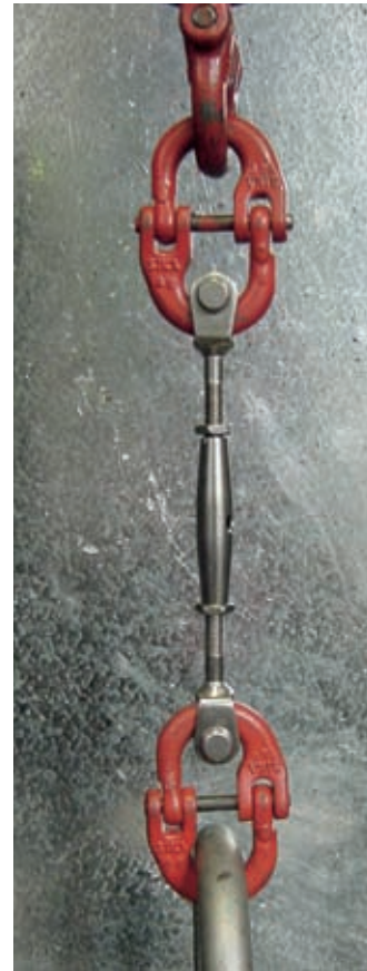
Essai de rupture d'un ridoir.
